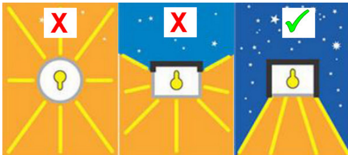
Abbildung: Schematische Darstellung der Ausleuchtung in Abhängigkeit von der verwendeten Abschirmung des Leuchtmittels. Links: Ohne Abschirmung, Mitte: Unzureichende Abschirmung. Rechts: Ideale Abschirmung mit nur nach unten gerichtetem Lichtkegel.
